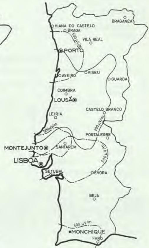
Fig. 2 — Curvas limites de cobertura dos emissores
