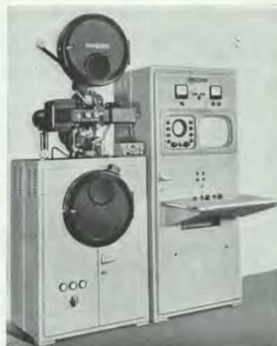
Fig. 11 — Aparelhagem de telecinema para fitas de 16 mm
