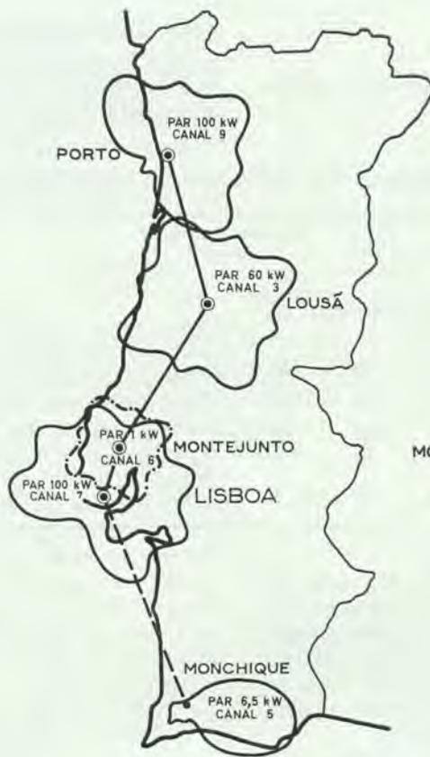
Fig. 1 — Diagrama de radiação das antenas dos emissores
