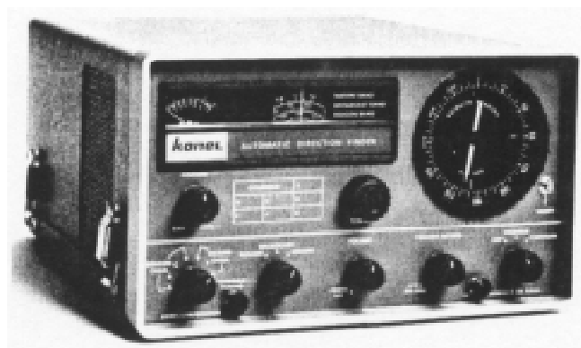
Figura 35.12 – Radiogoniômetro Automático com Indicador Analógico (Rosa Graduada)
