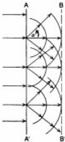
Figura 6.10: Princípio de Huygens aplicado à propagação de ondas planas.
